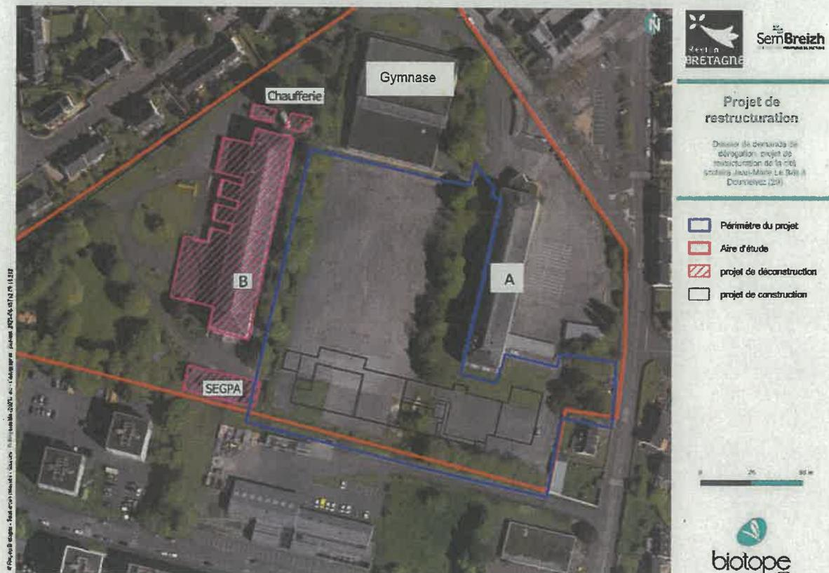
Figure 4 : Description du projet simplifié avec la destruction des bâtiments B et SEGPA et la construction du nouveau bâtiment prévu en phase APS
