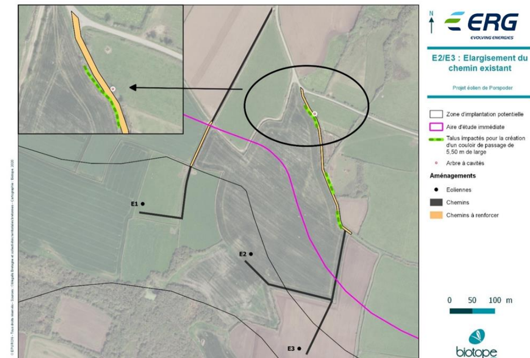
Figure 142 : Création d'un couloir de passage pour l'accès aux éoliennes 2 et 3
