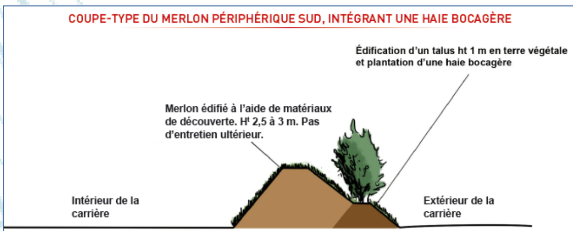
Fig. 38 : Coupe schématique du futur merlon
