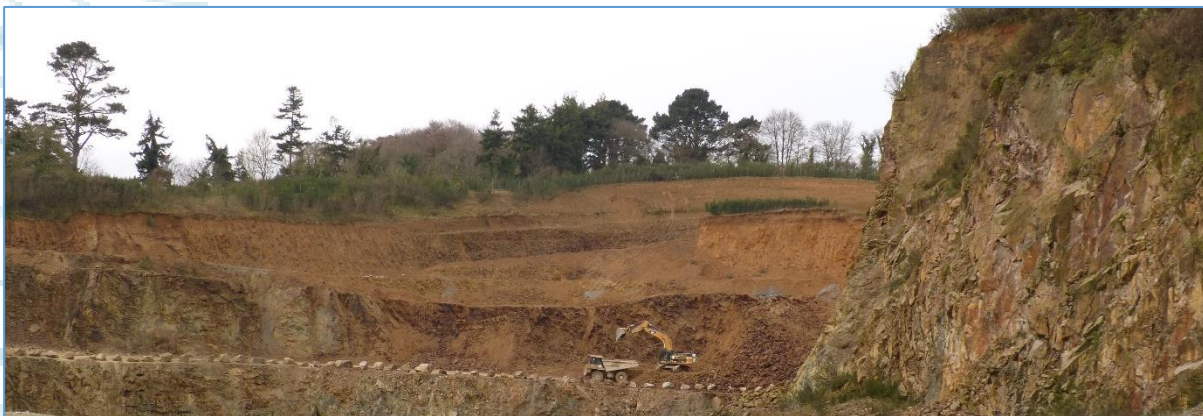
Fig. 17 : Vue n°8 : Reprise des matériaux bruts en pied de front à la pelle
