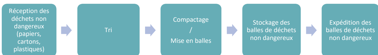
Figure 155 : Synoptique simplifié des activités de mises en balles
