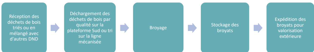
Figure 26 : Synoptique simplifié des activités de broyage de bois mises en œuvre
