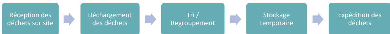
Figure 23 : Synoptique simplifié des activités de transit, regroupement, et tri mises en œuvre
