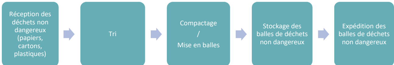
Figure 37 : Synoptique simplifié des activités de mises en balles
