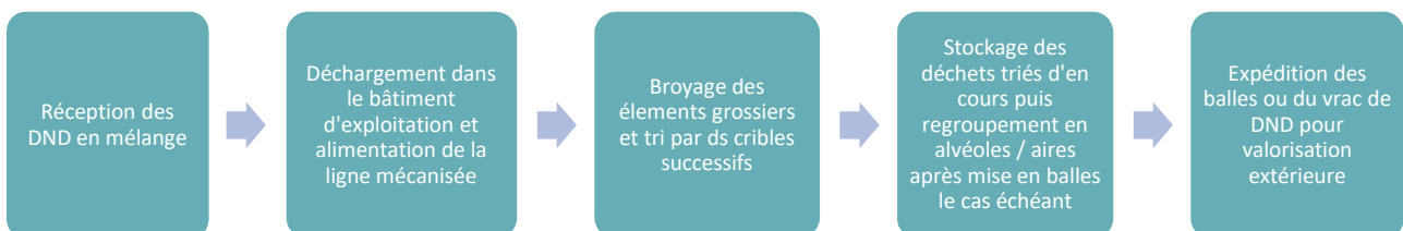
Figure 25 : Synthétique simplifié des activités de broyage de bois mises en œuvre
