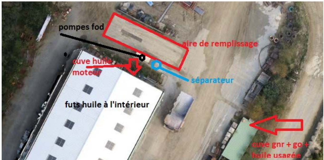
Localisation des stockages d'hydrocarbures sur photo aérienne
