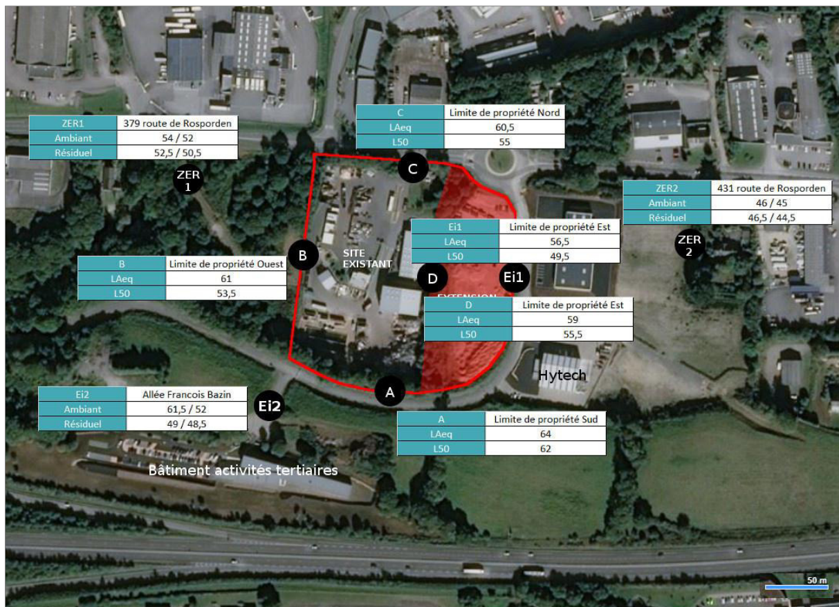
Figure 65 : Synthèse des niveaux sonores mesurés sur et aux abords du site (2 campagnes)
