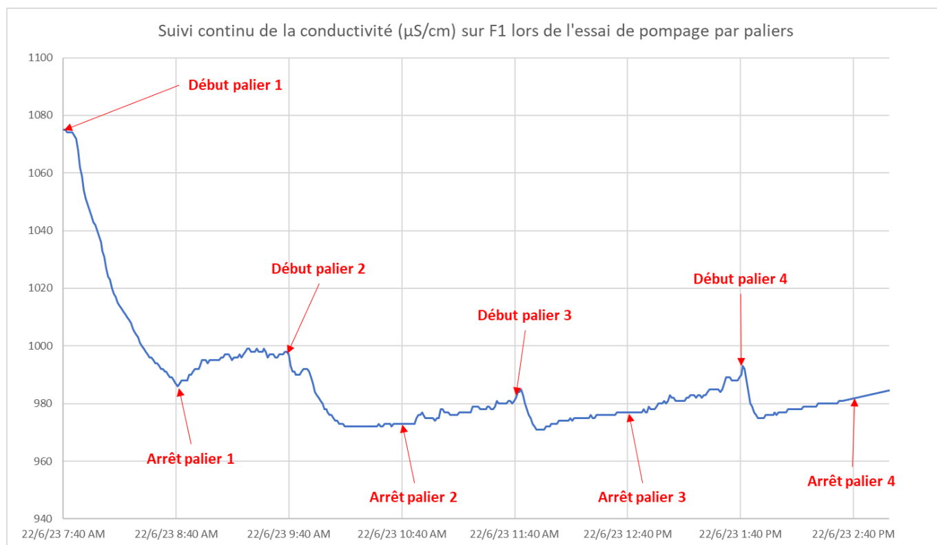
Figure 19 : Suivi en continu de la conductivité sur F1 lors de l'essai de pompage par paliers
