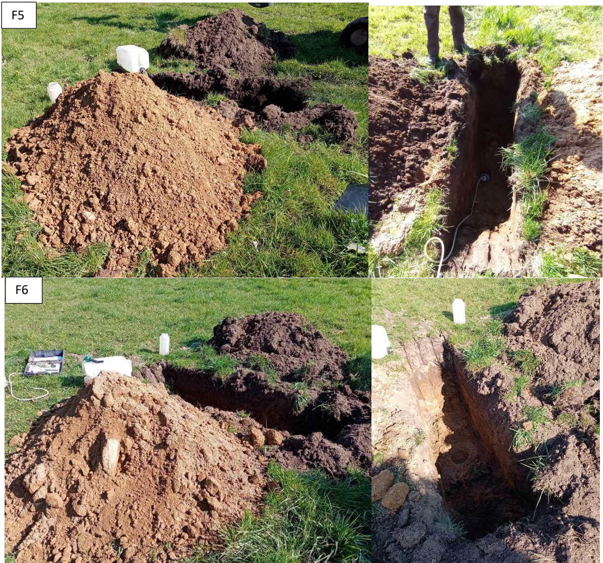
Figure 10 : Sondage à la tarière et test de perméabilité
