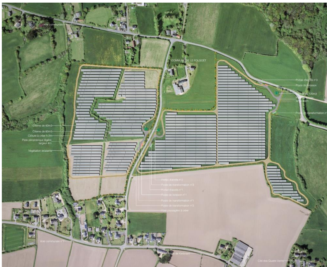
Plan masse sur fond topographique de la centrale photovoltaïque de Le Folgoët
