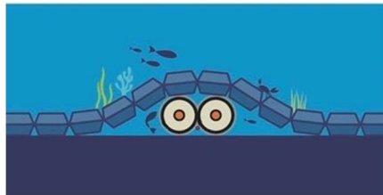
matelas béton (L : 6 m ; l : 3 m ; h : 3 m)
