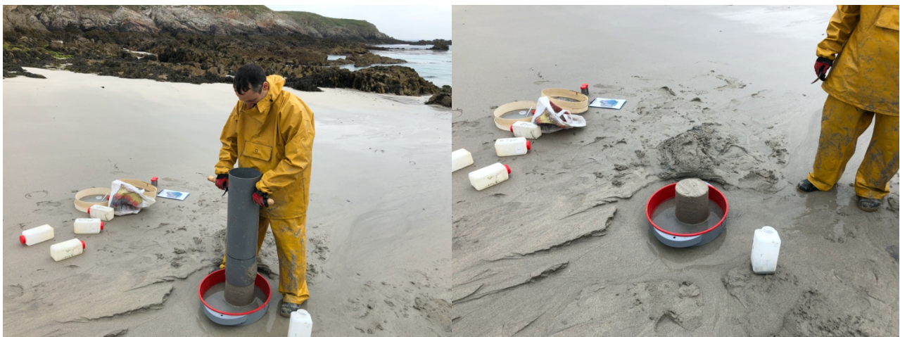
Figure 10 : Démoulage de la carotte dans le tamis
