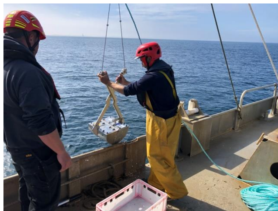
Figure 1 Benne Van-Veen utilisée lors de l'échantillonnage de la partie subtidale.
