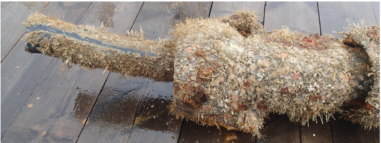
Figure 51 : Vue de la protection en fonte du câble export sur la pièce de courbure. L'ensemble est complètement colonisé que ce soit le câble avec son revêtement plastique ou la coquille de fonte.
