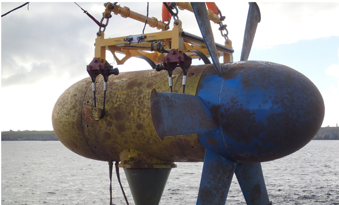
Figure 42 : Nacelle lors de son relevage le 13 juillet 2016 (source Sabella)
