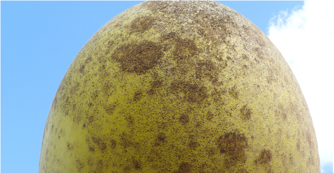
Figure 54 : Bulbe arrière. On observe une colonisation inférieure à 50 %, avec les balanes qui ressortent et des tâches d'hydrides qui se sont développés par bourgeonnement radiant (source Sabella)
