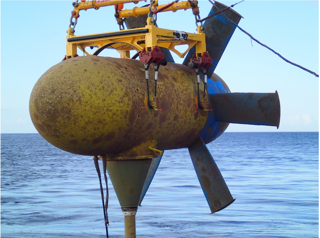
Figure 52 : Sur cette vue de la nacelle de 50 à 75 % des surfaces sont colonisées (source Sabella)
