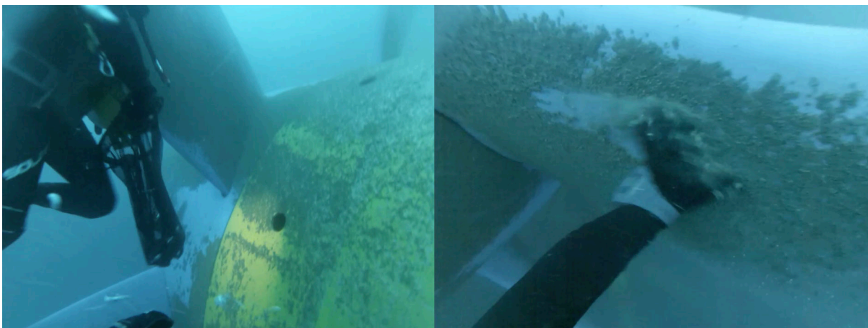
Figure 49 : Plongée du 16 avril 2016. La nacelle comme le bulbe avant sont colonisé par une couche muscinante de plus en plus grande. Le plongeur semble pouvoir l'enlever avec sa main facilement (source Sabella).
