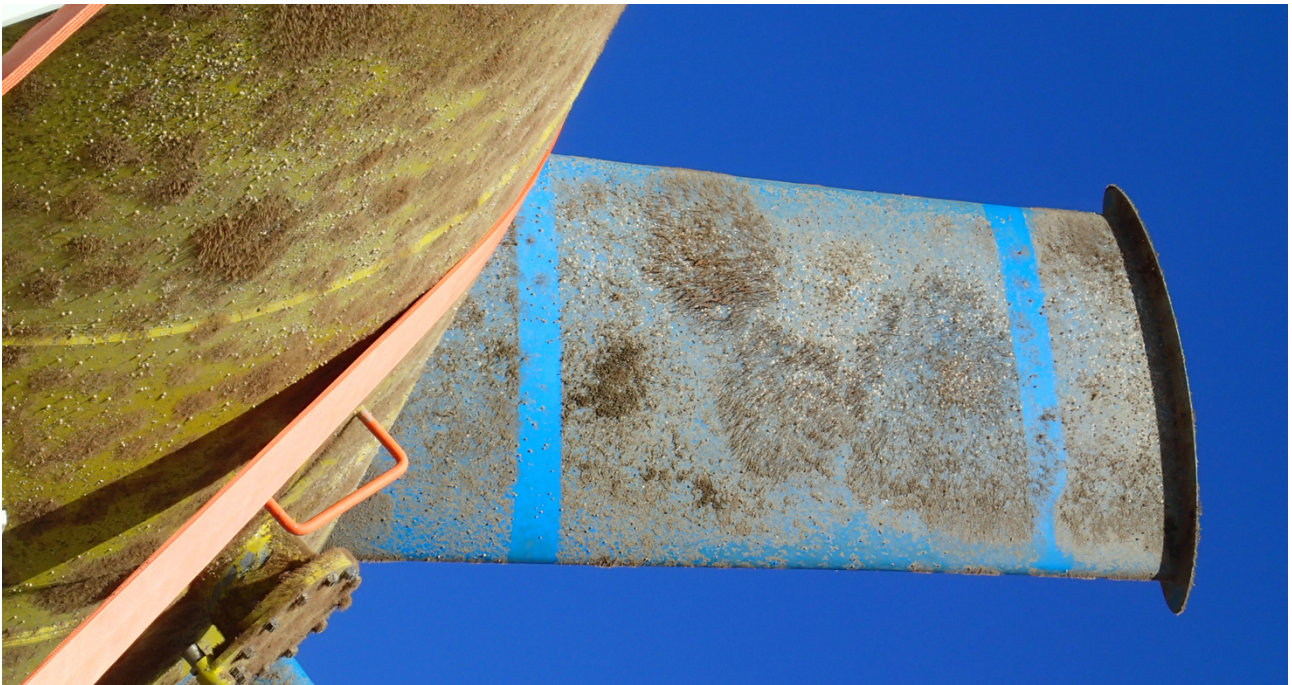
Figure 55 : Pâle du rotor. On voit que la colonisation est moins importante au niveau de bandes de test de peinture anti-fouling (AF SPC durçi de Nautix), cependant, des balanes commencent à coloniser ces zones.
