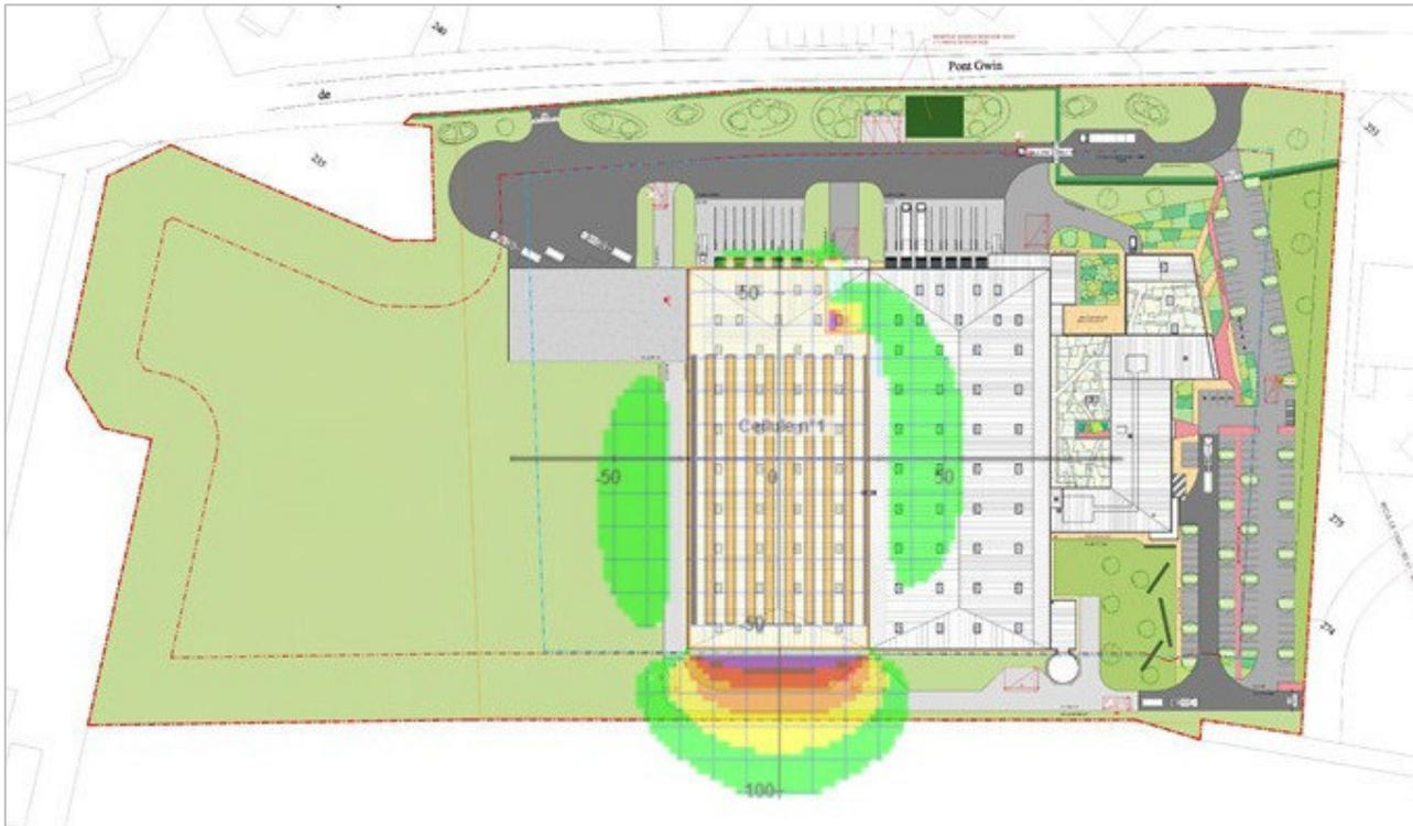
Figure 3 : Représentation des effets thermiques du scénario Sc2 sur le plan de masse
