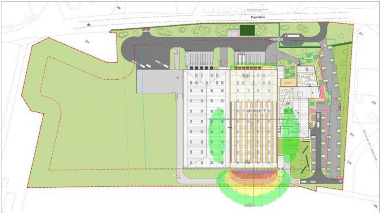
Figure 2 : Représentation des effets thermiques du scénario Sc1 sur le plan de masse
