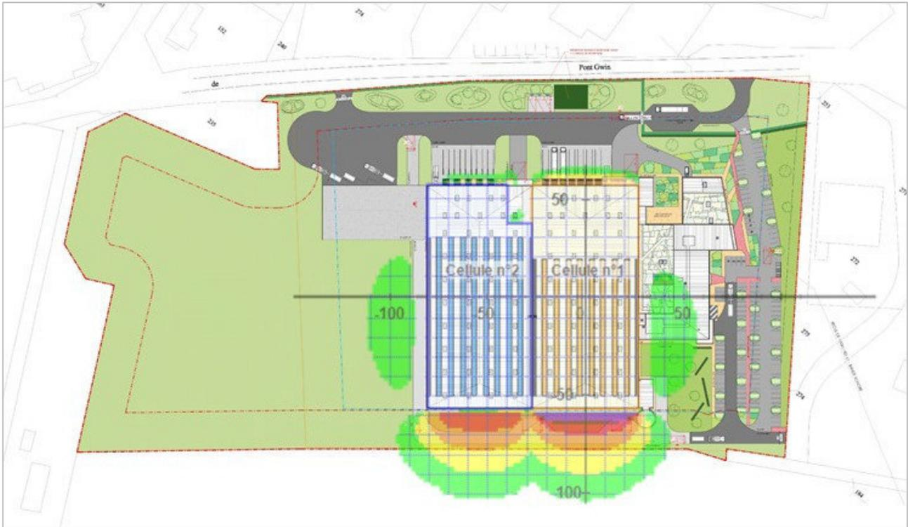
Figure 4 : Représentation des effets thermiques du scénario Sc3 sur le plan de masse
