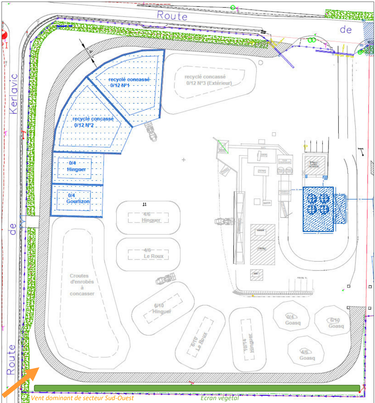
Figure 17 : Stockage par granulométrie (partie Ouest du site) et point source de poussière
