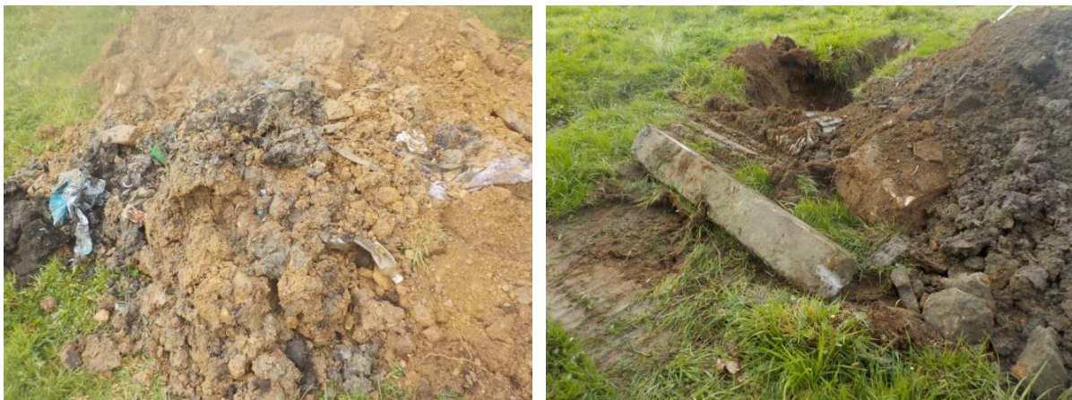
Figure 12 : Déchets ménagers fosse n°5 - Déchets de démolition fosse n°2 (Ouest Am')
